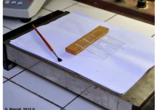
▲ Mise en réserve des lames portant les coupes et séchage, sur un chauffe-plat, en position inclinée.
