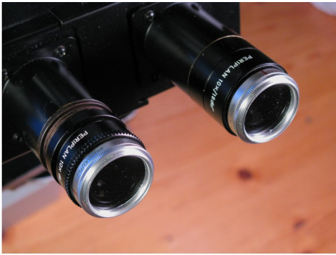
Analyseurs vissés sur des oculaires Leitz-Periplan
