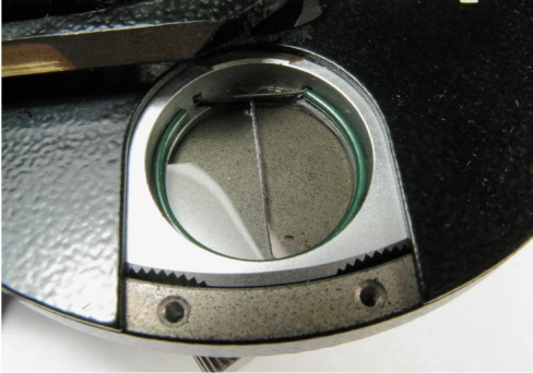
Montage du polariseur double dans le barillet du condensateur à contraste de phase Leitz 402a
