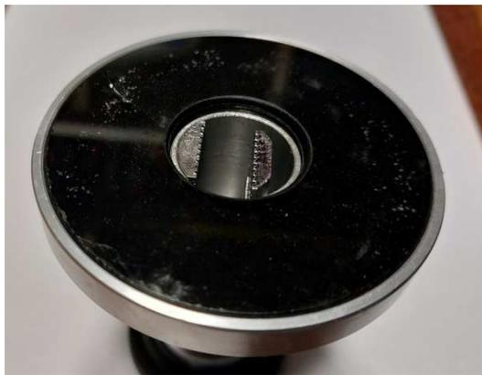
La platine a en son centre un cylindre creux dans lequel une partie mobile circule de haut en bas ; elle contient des mâchoires destinées à recevoir les spécimens à couper.
