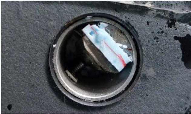
Positionner l'ensemble dans le cylindre et puis fermer les mâchoires à l'aide de la vis comme indiqué sur la photo ici à gauche.
