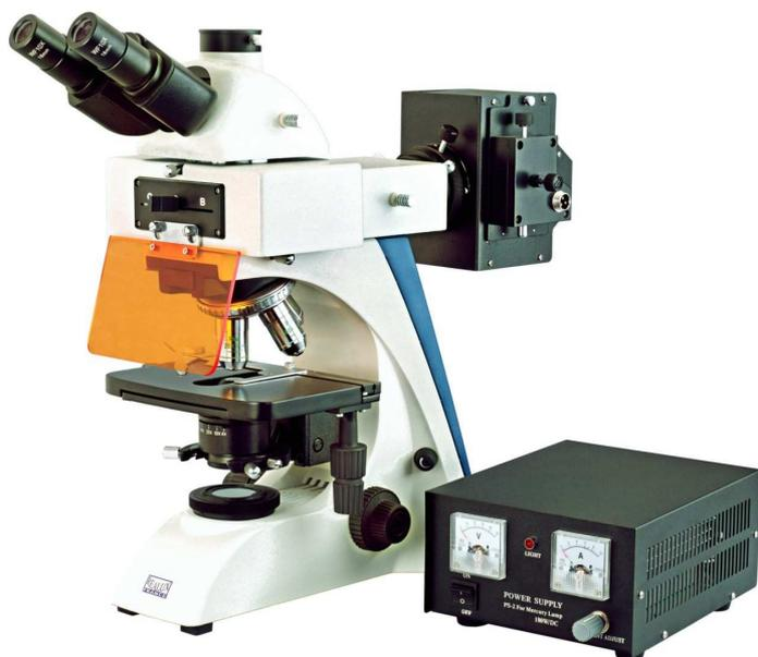
La fluorescence est la propriété que possèdent certains corps d'émettre de la lumière après avoir absorbé des photons de plus haute énergie. La microscopie en fluorescence repose sur la formation d'une image par détection de cette lumière émise.
