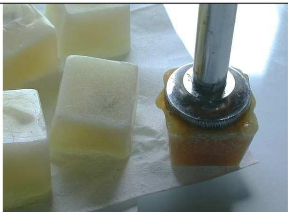
Le bloc de PEG est fixé à chaud sur le mandrin de support du microtome
