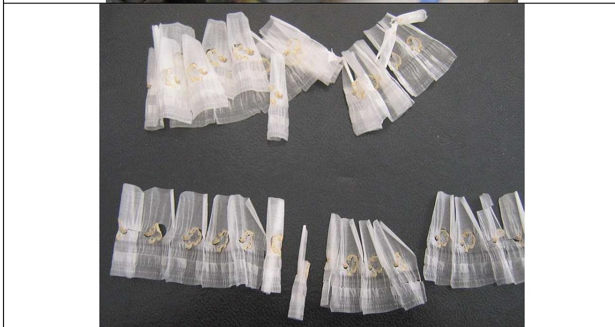
**Le microtome en action, sur des blocs de paraffine : les rubans se forment sur la lame, sont recueillis sur la main ou une feuille de papier ; on voit nettement la coupe au centre des tranches**
