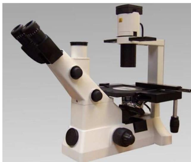
**Le microscope inversé** permet l'observation d'échantillons éclairés par le dessus, avec des objectifs à longue distance focale, qui sont situés en dessous de la platine, et donc de la préparation. Le système optique est aménagé de manière à ce que les oculaires se trouvent dans une position « normale » pour l'observateur.
