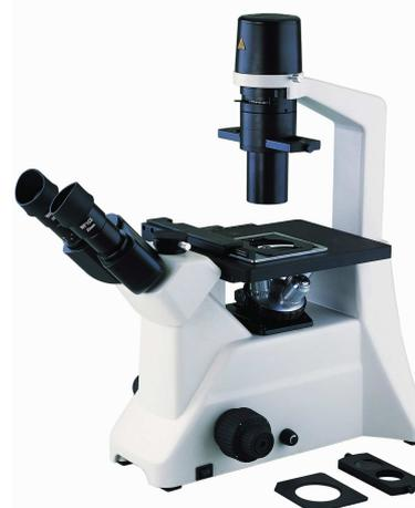
Pour la cristallographie et la métallographie<sup>12</sup>, sciences ou technologies qui demandent à observer des objets complètement opaques, ou trop épais pour le processus de transmission, des microscopes particuliers ont été développés, en utilisant la lumière blanche ou la fluorescence, mais en réflexion. Cela signifie que la source lumineuse se trouve au-dessus du statif, du même côté que l'observateur. On va alors parler d'éclairage épiscopique.
