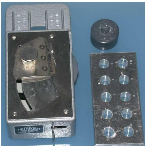
Le dispositif de coupe est une lame pour rasoir mécanique, solidement fixée sur une partie mobile qui coulisse sur le plateau du microtome, en un mouvement latéral très bien étudié. Une large molette permet de faire monter un cylindre qui renferme le dispositif de serrage et la pièce à couper.
