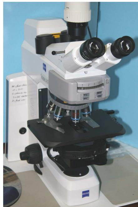
*Un « monstre » de technologie : le Zeiss AxioScope A1, équipé en fluorescence, contraste de phase, contraste interférentiel de Nomarski, fond noir, polarisation, 6 objectifs à l'infini, avec éclairage par leds (épiscopie et diascopie).* (Photo Marcel Lecomte)
