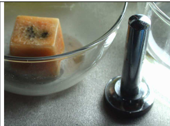
Un bloc de PEG qui vient d'être démoulé
