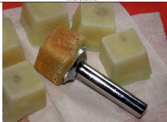
Le bloc de PEG est fixé sur le mandrin de support du microtome
