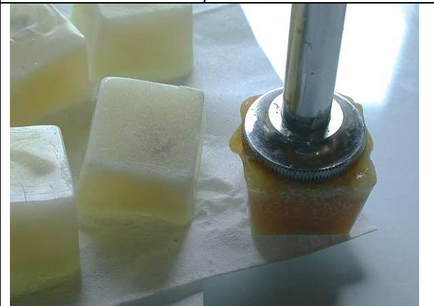
Fixation à chaud du bloc sur la tige de support du microtome
