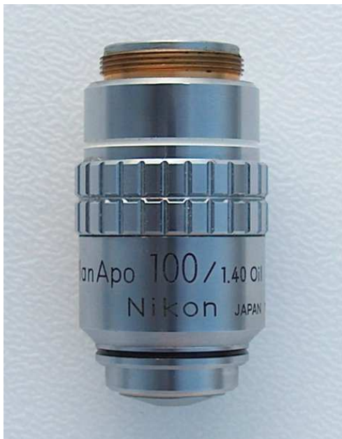
Photo 10 : cet objectif planapochromatique 100x à immersion, avec un n=1,40 est une merveille technologique
