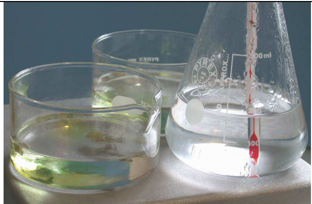
inclusion en cours sur plaque chauffante régulée
