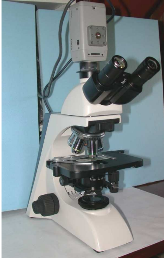
Photo 08 : microscope trinoculaire BKX5000 (mon maître-achat actuel) équipé d'une caméra numérique
