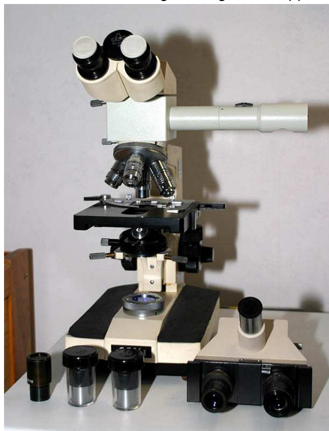
Photo 4 : modèle avec tube à dessiner et tête trinoculaire amovible, de marque Paralux
